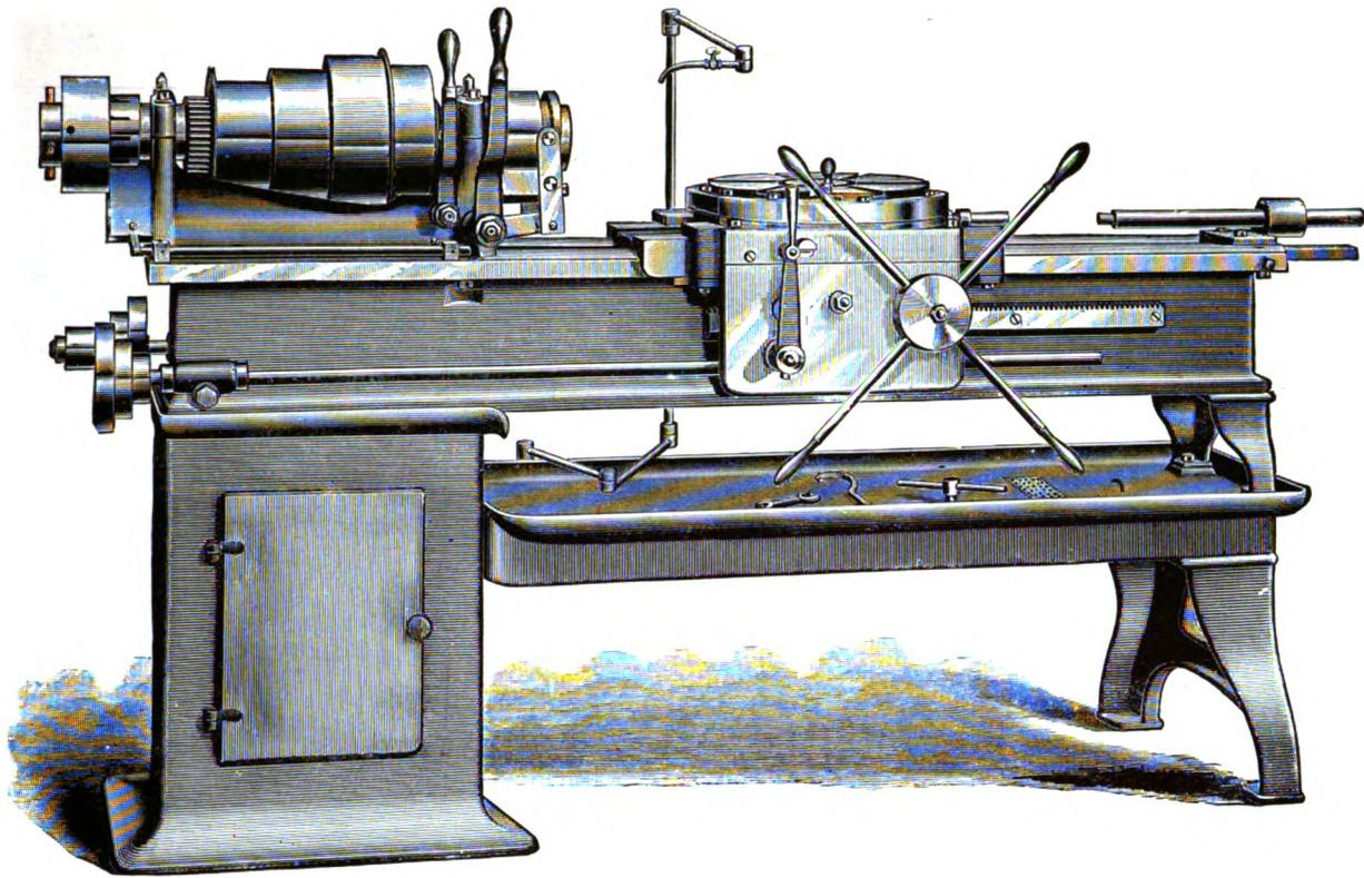
Fig. 3.—THE 2 x 24 FLAT TURRET LATHE.—FRONT VIEW.
