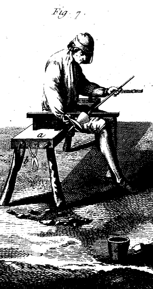
Verrerie en bois, l'opération de remuer la Composition dans le Pot de fonte, de cueillir la matiere ou Poste, de la rouler sur le marbre, de la souffler dans le moule, et autres opérations relatives à la façon d'un verre.
